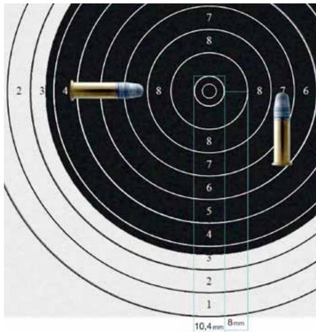
Die 50-m-Scheibe hat einen Durchmesser (Ringe 1–10) von 154,4 mm, der schwarze Spiegel misst total 112,4 mm. Die Breite der Ringe 1–9 beträgt 8 mm. Der Zehner hat 10,4 mm Durchmesser, die Innenzehn („Mouche“) 5 mm.
