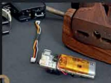
Kabel beim Elektronikmodul austauschbar (E)
