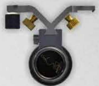
Im Gegensatz zu den Vorgänger-Modellen ist der MX-02 kein Infrarot-Sensor, der auf die Strahlen der Leuchtdioden im Rahmen reagiert. Dieser SCATT ist eine Kamera, die lediglich eine schwarze Scheibe mit hell erleuchtetem Umfeld benötigt. Dieser Fortschritt wird möglich, weil es inzwischen hochauflösende und kleine Chips gibt. Vorteil ist insbesondere der Verzicht auf jedwede Leuchtquelle an der Scheibe.
