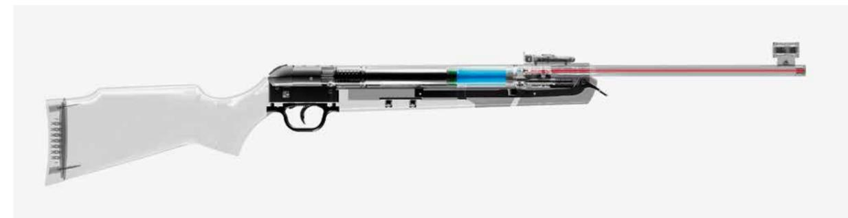
Beim Spannen schiebt der mit einem Hebel verriegelte Knicklauf dieses **Federdruck-Luftgewehrs** (Walther LGV) über ein Gestänge den Kolben gegen Federkraft zurück, bis er einrastet. Dann schwenkt man den Lauf wieder in die Schießposition zurück. Die Luft im Kolbenraum (blau) würde beim Vorschnellen des Kolbens zusammengepresst und das Geschoss durch den Lauf jagen.
