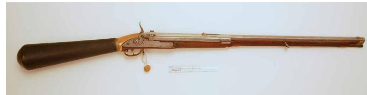
Bartolomeo Girardoni baute ab 1780 dieses österreichische **Pressluft-Militärgewehr**. Der Kolben diente als Tank, 22 Rundkugeln in 11,76 mm lagerten im Röhrenmagazin seitlich am Lauf. Bei hochgehaltener Mündung rollte jeweils die unterste Kugel in einen Seitenschieber und wurde durch Zurückdrücken nach links an den Laufansatz gebracht. Ein volles Magazin konnte so in nur einer Minute abgefeuert werden. Heutige gut erhaltene Exemplare liegen im hohen fünfstelligen Euro-Bereich.
