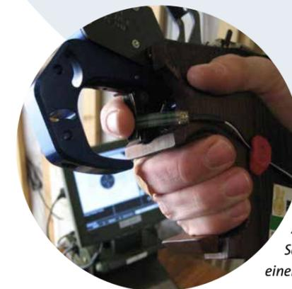
Aufgeklebter Sensor am Abzug einer Freien Pistole.
